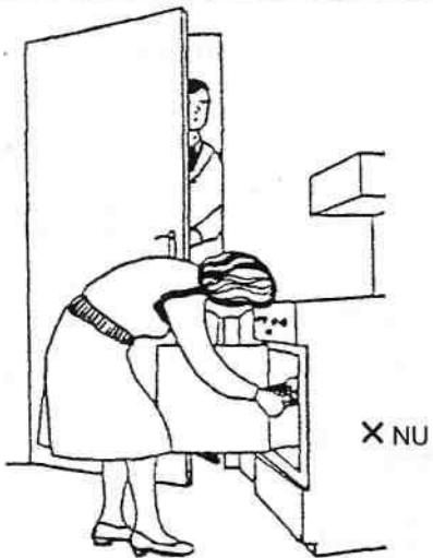
Amplasarea ușilor, precum și amenajările interioare, trebuie astfel concepute încât să nu se producă accidente prin coloziune
